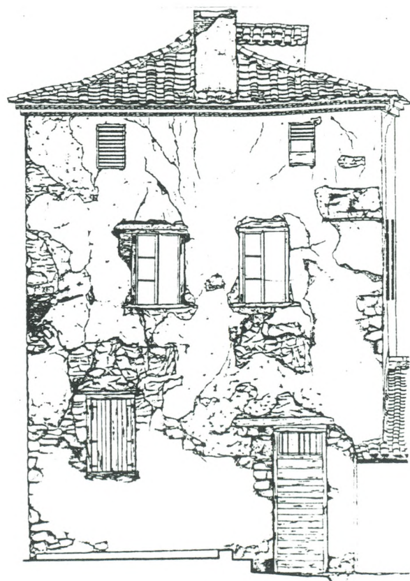
Εικ. 5 Πύργος Church. Οψεις. Υπάρχουσα κατάσταση. Κλ. 1:100 (Π.Γραμματόπουλος, Στ.Μαμαλούκος, Στ.Νέλλα και Χ.Πανουσάκης, Πύργος Church, Ειδική Οικοδομική, Σεπτέμβριος 1983)
