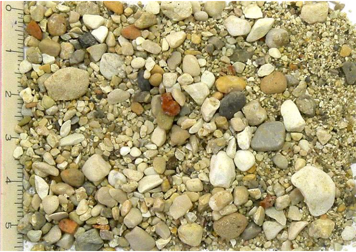
Εικ.16. Τα στρογγυλεμένα αδρανή του δείγματος κονιάματος ΑΦε4 μετά την αφαίρεση της συνδετικής κονίας.
