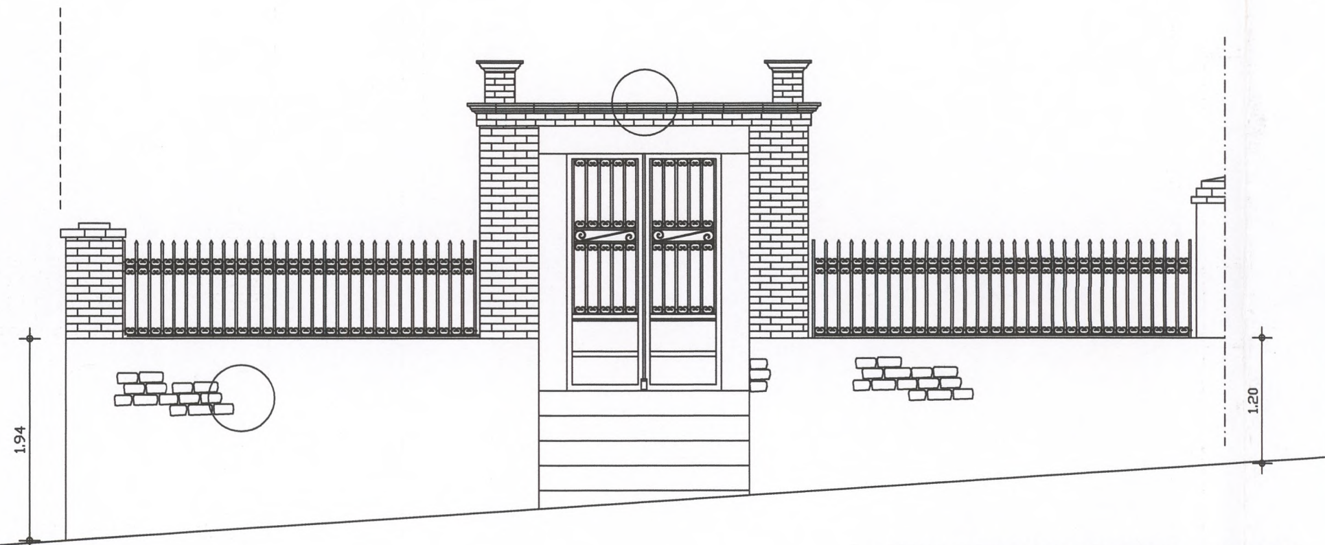
ΟΨΗ ΕΙΣΟΔΟΥ ΠΕΡΙΒΑΛΟΥΣΑΣ ΤΟΙΧΟΠΟΙΑΣ ΝΑ 1:50
