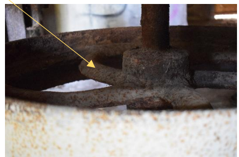
Φ48. (2021) Ο δεύτερος ηλεκτροκίνητος αλευρόμυλος του ισόγειου κτίσματος, που περιστρεφόταν με ιμάντες κίνησης.
