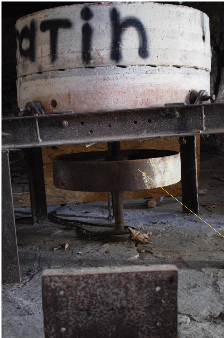
Φ48. (2021) Ο δεύτερος ηλεκτροκίνητος αλευρόμυλος του ισόγειου κτίσματος, που περιστρεφόταν με ιμάντες κίνησης.
