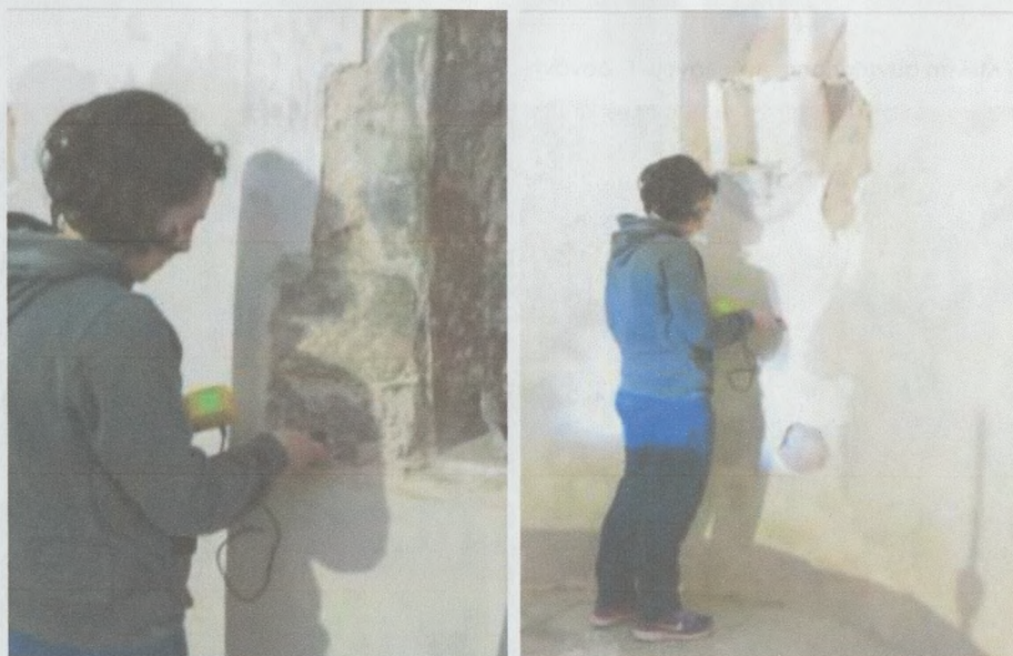
Εικ. 44 α,β, Μετρήσεις της υγρασίας σε διάφορες στάθμες στο εσωτερικό του ναού.
