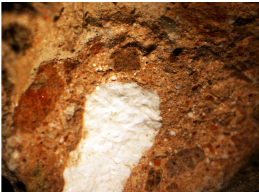
Εικ.23. Εικόνα μικροσκοπίου 15X από το κονίαμα του μαρμαροθετήματος διακρίνεται θραύσμα λευκής ψηφίδας που περιβάλλεται από κονίαμα με θραυστό κεραμικό.
