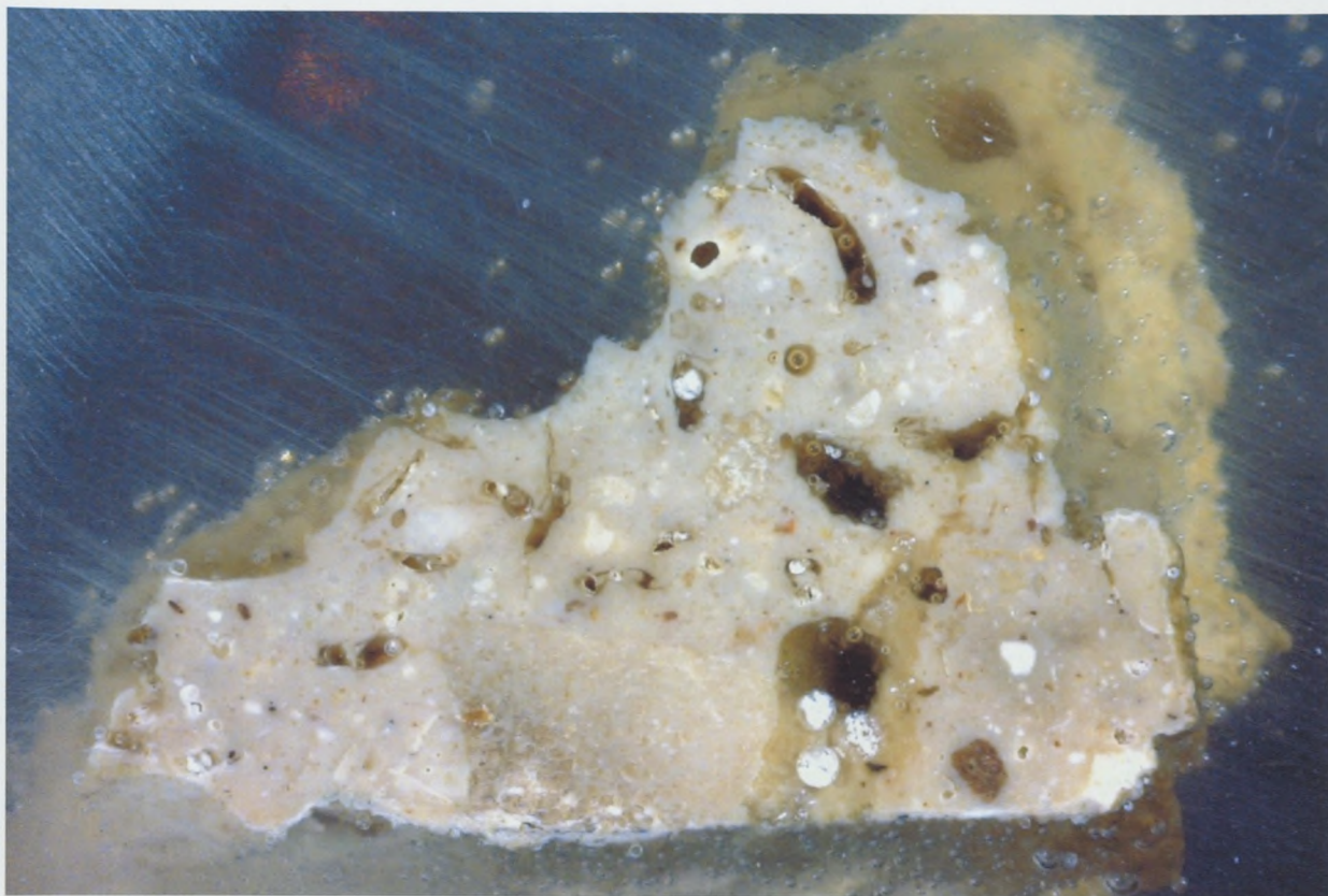
φωτ.81 Αρχικό υπόστρωμα χρωματικής επιφάνειας Ασβεστοκονίαμα με τριμένο άχυρο και λεπτόκοκκα αδρανή
