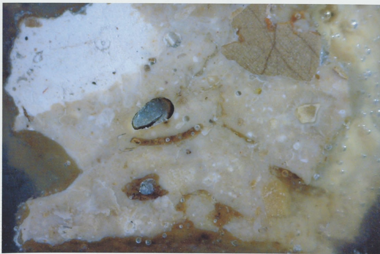
φωτ.90 Ασβεστοκονίαμα από την βόρεια πλευρά (αποκολλημένο κομμάτι που βρέθηκε εντός της κόγχης) Διακρίνονται τα αδρανή, το άχυρο και ένα μεγάλο κομμάτι ασβέστη.
