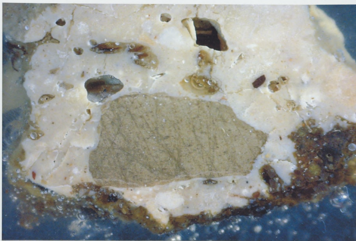
φωτ.83 Αρχικό υπόστρωμα χρωματικής επιφάνειας Ασβεστοκονίαμα με τριμένο άχυρο και χονδρόκοκκα αδρανή. Στην κάτω πλευρά διακρίνεται σκουρόχρωμη στρώση επικαθίσεων
