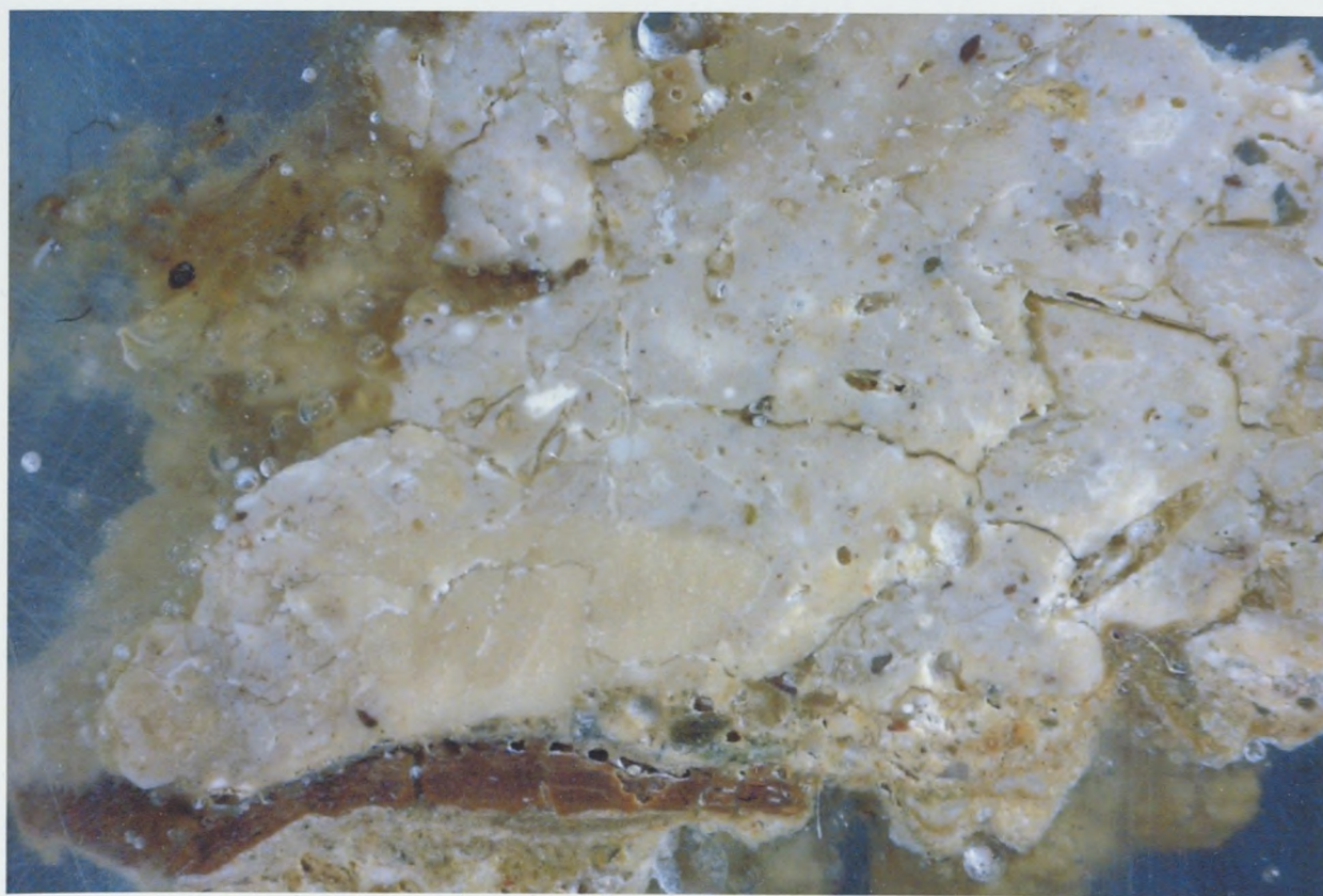
φωτ.84 Στερεοσκοπική φωτογραφία υποστρώματος ζωγραφικής επιφάνειας από τον Δυτικό τοίχο Η σκούρα λωρίδα είναι από επικάλυψη κεριού
