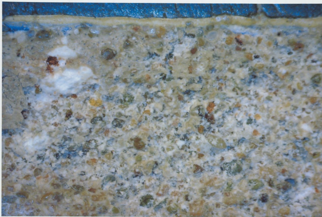
φωτ.85 Τσιμεντοκονία από τη θέση της Πλατυτέρας. από τον ανατολική πλευρά Στο ανώτερο σημείο η μπεζ στρώση είναι δυσδιάλυτα άλατα
