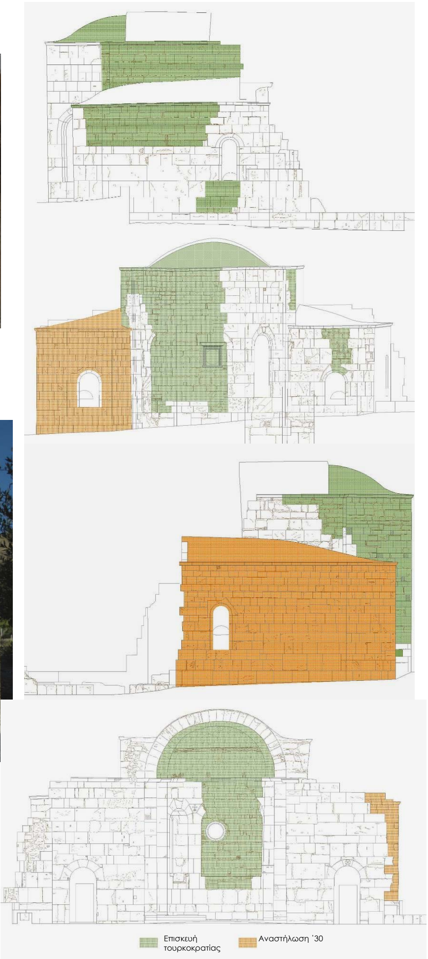
Εικ.9. Ο ημισφαιρικός θόλος του ιερού εικάζεται ότι κατασκευάστηκε επί τουρκοκρατίας, καθώς οι θολίτες είναι μικρότεροι από αντίστοιχους σε θόλους της αρχικής κατασκευής
