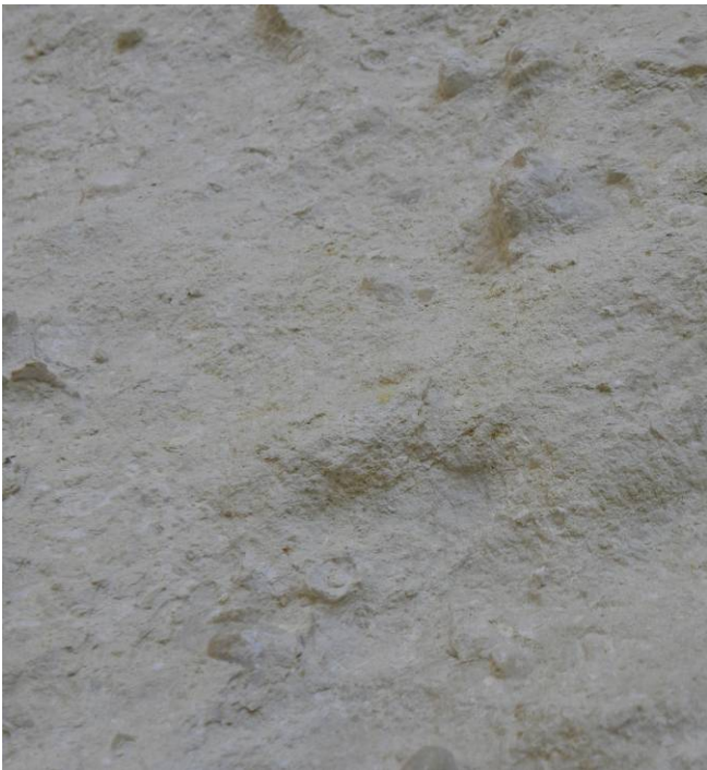
Εικ.11. Μακροφωτογράφιση της επιφάνειας του λευκού λίθου στην οποία διακρίνονται κατά τόπους κοχύλια και βότσαλα.
