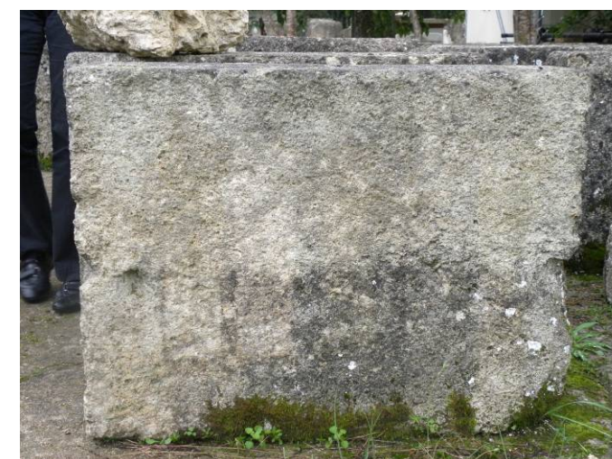
Εικ.44-46. Δοκιμαστική εφαρμογή βιοκτόνων σε διαδοχικές φάσεις σε κογχυλιάτη λίθο στην αρχαία Ολυμπία.
