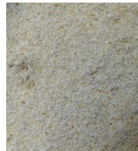
Εικ.17. Μακροφωτογραφία του βασικού οικοδομικού υλικού του ψαμμίτη..
