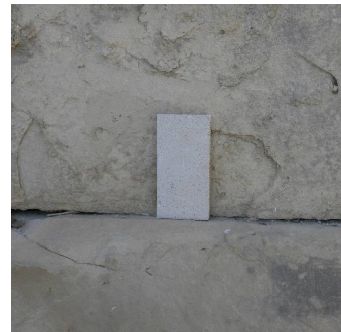
Εικ.47. Δείγμα ψαμμίτη από λατομείο της Κρήτης.
