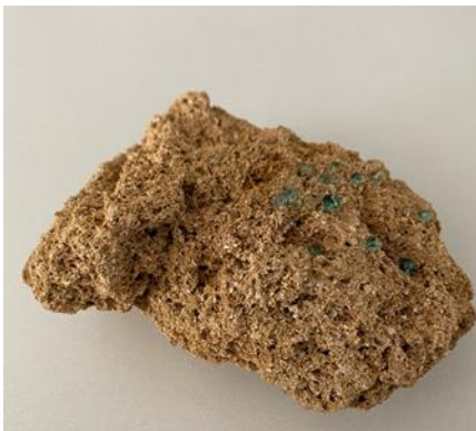
Εικόνα 82: Ιστορικός ψαμμίτης με επιφανειακή εφαρμογή του υλικού στερέωσης.
