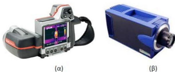
Εικόνα 76: Υπέρυθρες θερμικές κάμερες: (α) LWIR θερμική κάμερα FLIR ThermoCAM T360, με FPA 320x240 pixels, φασματική απόκριση 7.5–13 \mu\text{m} . (β) MWIR θερμική κάμερα CEDIP/JADE με ανιχνευτή InSb και FPA 320x240 pixels, φασματική απόκριση 3.6–5.0 \mu\text{m} (Ματίκας, 2015).
